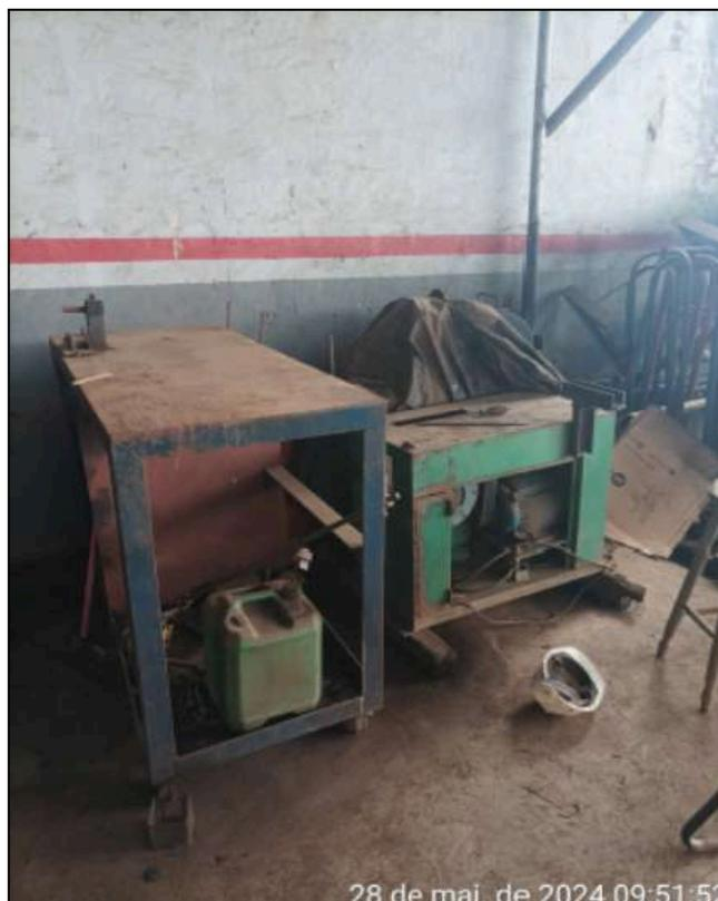
**Imagem 2: máquina de cortar vergalhão verde (faltando braço de corte) - máquina de dobrar vergalhão azul até 10 mm**
