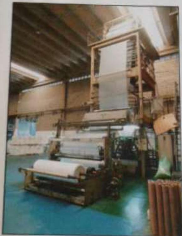
Extrusora Rulli 80 – Largura útil 2.100mm -c/ Tratamento Corona de 1.700mm.
