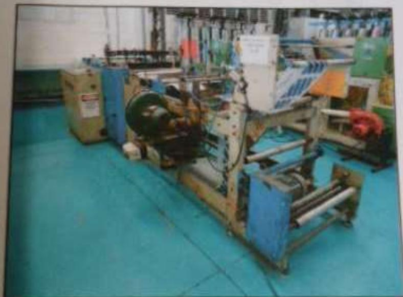
Máquina Corte e Solda Setormaq – 600 Modelo solda SPI..
