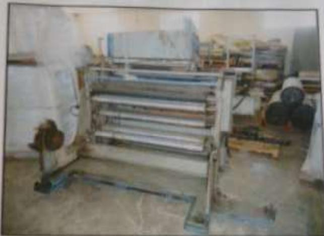
Máquina rebobinadeira Prosfama 1.020mm.
